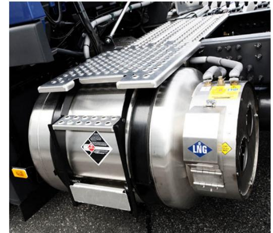
Tanques / Cilindros de diseño especial son utilizados para almacenar GNC ó GNL.
